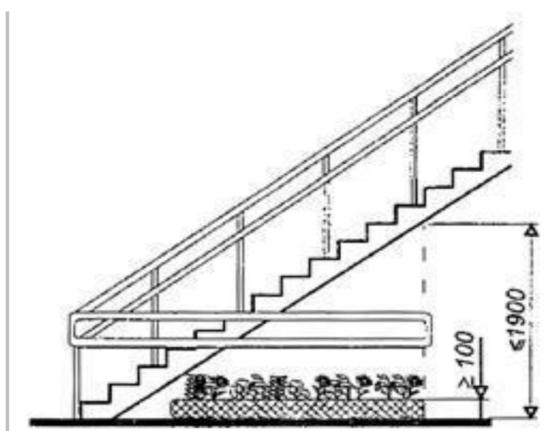
Предохранительная защита или поручни в зоне опасности
