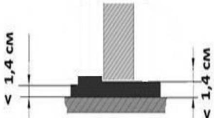
Измеряется вертикальная часть порога. Высокие пороги непреодолимы для колясочников. Доступность при пороге более 2,5 см условная. Измеряется самый высокий порог.
