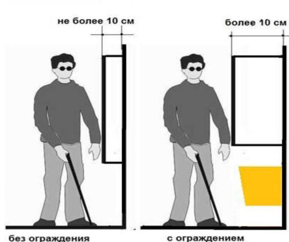
При обследовании фиксируются выступы на путях движения более 10 см и без ограждения снизу.
