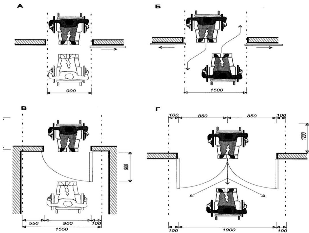
Минимальные габариты свободных площадок с обеих сторон дверного проема раздвижных однопольных (А) и двупольных (Б) дверей, распашных однопольных (В) и двупольных (Г) дверей
