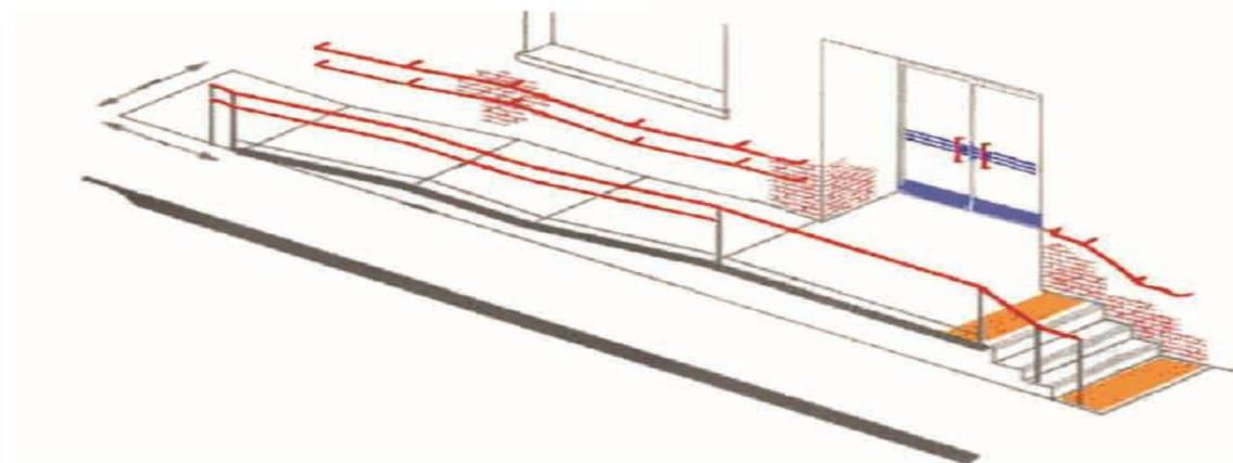
На рисунке показан оптимальный вход в здание, который одновременно имеет и удобный пандус нужной ширины и ступени, оборудованные с обеих сторон поручнями. Дверь должна открываться в сторону, противоположную от пандуса, так как в противном случае могут возникнуть ситуации, в которых инвалид-колясочник, заехав на лестничную площадку, может получить удар открывающейся дверью.
