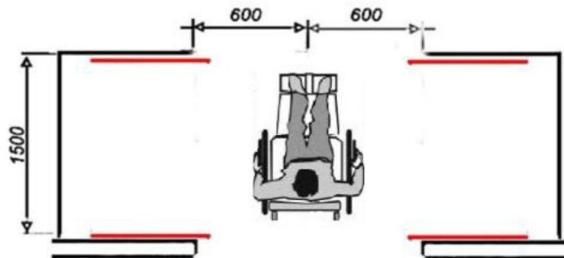
СП 59.13330 5.2.33 На путях эвакуации допускается применение раздвижных дверей при условии, что они:
